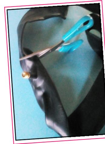
Con las tijeras recortaremos la cámara de la bici para extraer la válvula de admisión del aire. La recortaremos dejando bastante trozo alrededor, lo que nos facilitará el posterior pegado a la botella.
