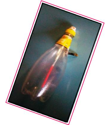
**Con la bomba de bici comprobaremos la estanqueidad del Spray casero, que no pierda aire.**
