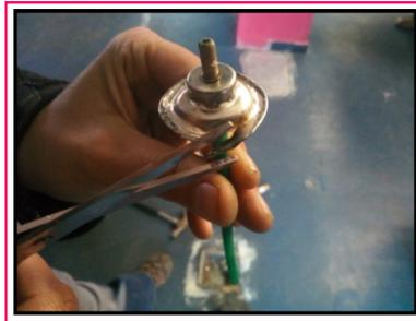
Con el pirograbador hacemos un orificio en el tapón de la botella, lo suficientemente grande para que quepa el círculo metálico de la válvula de salida.
